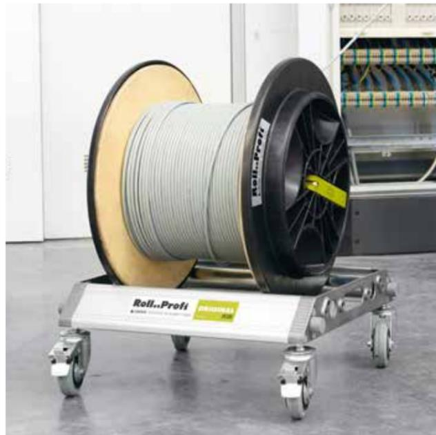
Durch die einfache Verstellung der Tragwalzen mittels Federkernachsen auf Abstand sind Kabeltrommeln in allen Größen bis max. 1.200 mm Durchmesser abzurollen. Selbstverständlich bietet unser ORIGINAL den maximalen Schutz gegen Verschmutzung und Korrosion durch den Einsatz von geschlossenen Tragwalzenlagern.
